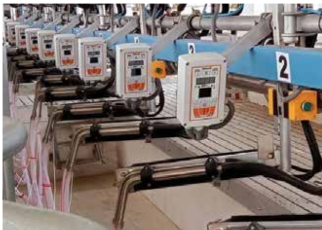
Izq.: El punto de ordeño Global IDS permite automatizar de manera integral el proceso de extracción de leche, garantizando el bienestar de la vaca y maximizando la eficiencia de la sala. Der.: Rodeg presentó los ventiladores RP-FAN 1240, un sistema aerodinámico de alta durabilidad que se acopla a sensores inteligentes para mitigar el estrés térmico.
